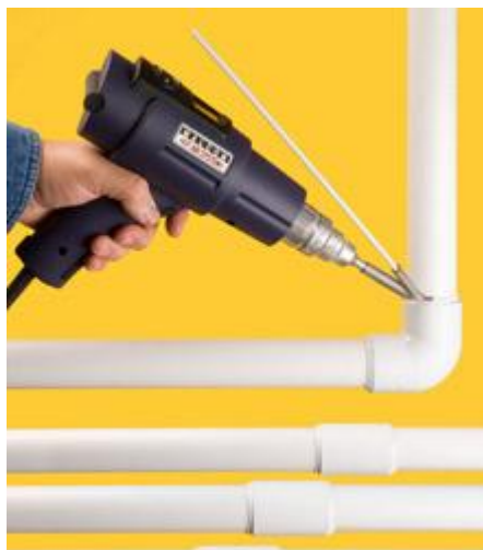
Obr. 3.3 Svarový spoj nahřátím materiálu
