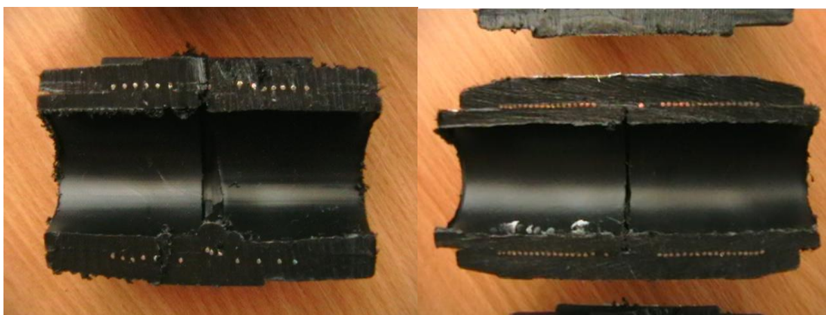
Nízká kvalita tvarovky (nesprávně uspořádaný drát)
