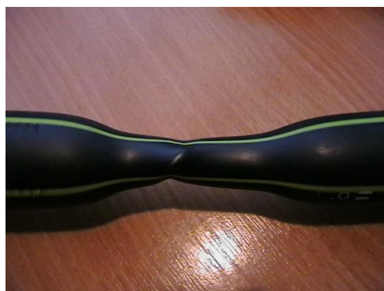
Obr. 8.6 Vzorek zkoušený tahem – houževnatý lom
