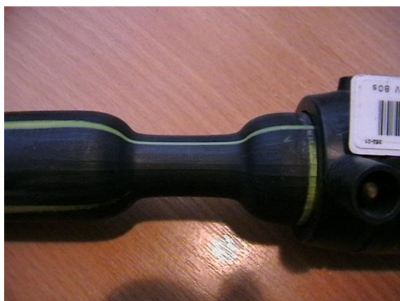
Obr. 8.6 Vzorek zkoušený tahem – houževnatý lom
