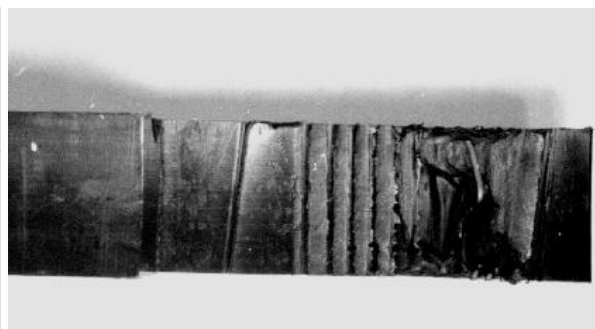
Částečně nesvařený spoj Obr. 8.2 Možné vady
