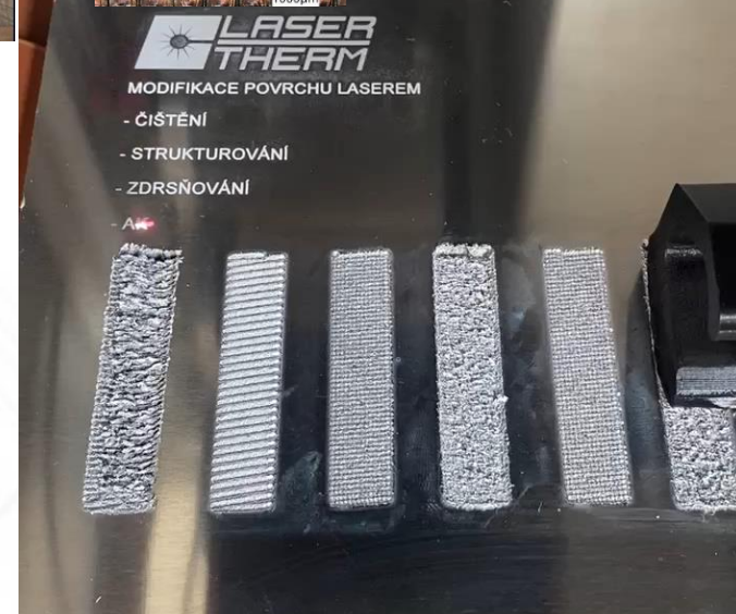
Zdrsňování a čištění – náhrada mechanického procesu. 6000 ks / směna
