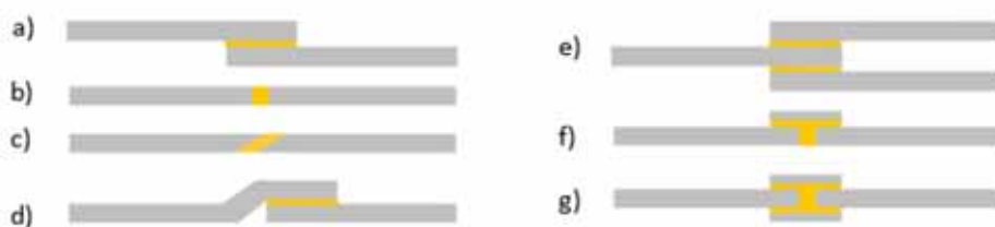
Obr. 3: Druhy lepených spojů: a) přeplátovaný spoj, b) tupý spoj, c) spoj zkosený tupý, d) spoj lemový, e) spoj dvojité přeplátovaný, f) spoj s příložkou, g) spoj s dvěma příložkami
