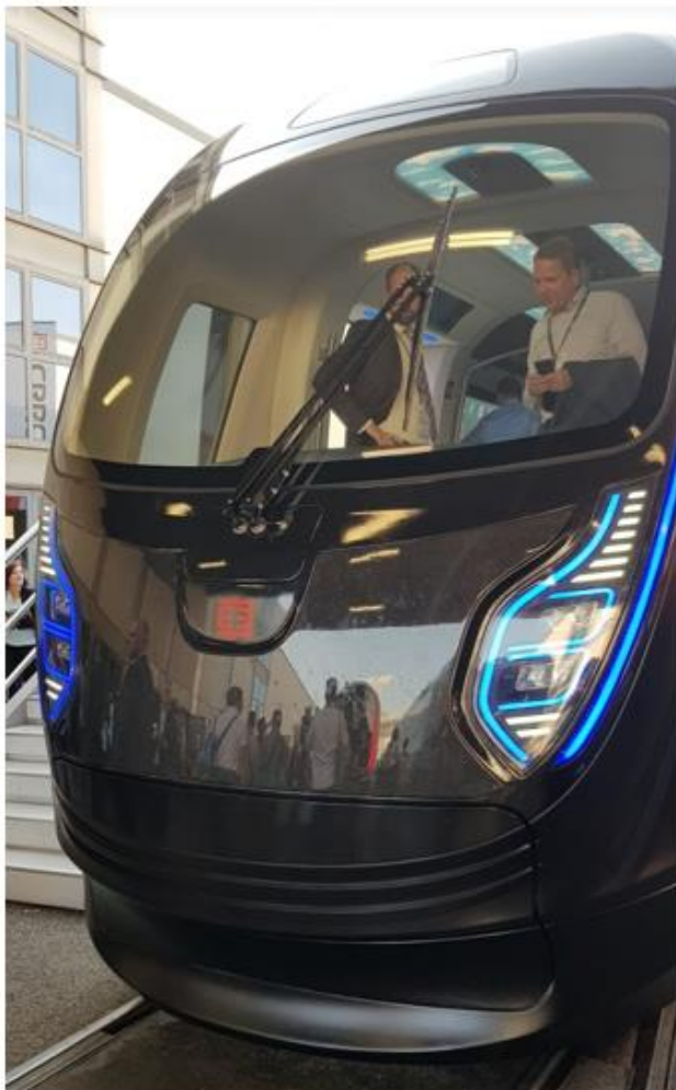
Konstrukce kolejového vozidla z uhlíkových vláken.
