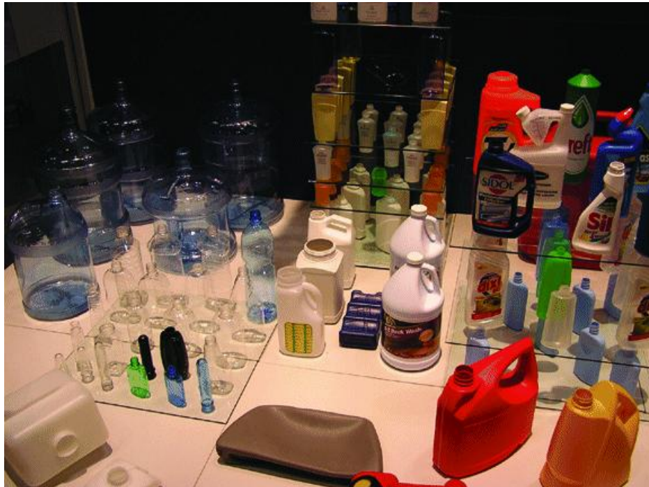
Obr. 2.20 Běžné profukované výrobky s určitými předem profouknutými vstříkovanými předběžnými tvary (trubicemi) vlevo od středu v popředí.
