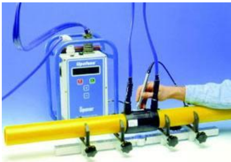
Obr. 4.1 Princip procesu elektrofúzního svařování
