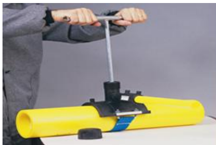
Obr. 5.19 Provrtání trubky pro vytvoření proudícího okruhu.
