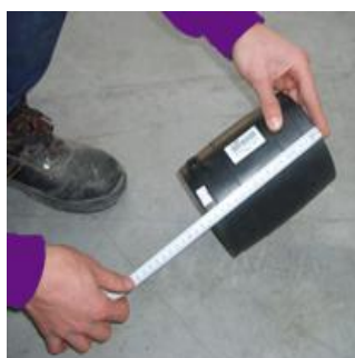
Obr. 5.3 Měření délky tvarovky
